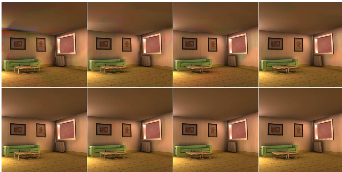
图 5-10 不同的CTA压缩率的绘制效果(采用的特征向量的数量/光照压缩后的维度)。第一行: 8/64, 16/64, 32/16, 32/32。第二行: 32/64, 32/96, 64/64, 参考图像
